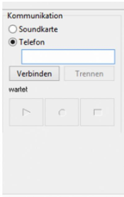
Pour cela, sélectionner „Téléphone“, saisir un numéro de téléphone et cliquer sur „Connecter“ pour voir si la ligne est libre. Selon l'installation du système téléphonique, il peut être nécessaire d'ajouter un „0“ pour la fonction devant le numéro de téléphone.
